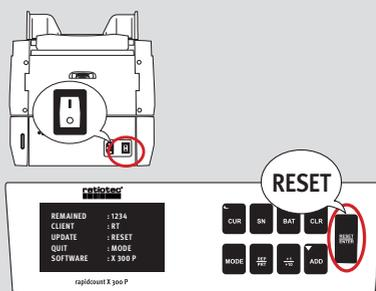
4. Alle erforderlichen Updates werden nun durchgeführt, dies kann ein paar Sekunden dauern. Nach erfolgreichem abgeschlossenen Update wird die Meldung „Please Restart Machine“ im Display angezeigt.
